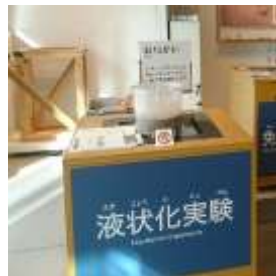
液状化現象実験装置
